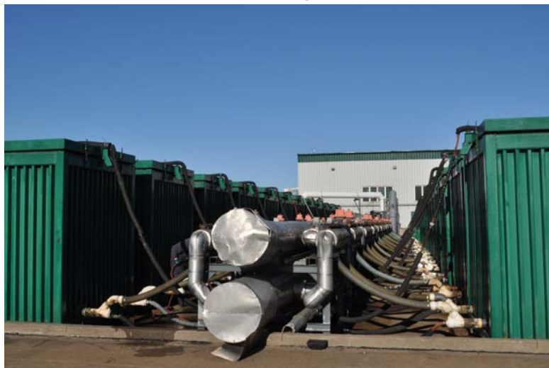
Figure 18: Systèmes fermés modulaires statiques en contenant rigide pouvant être raccordés à des unités supplémentaires ou à un système de ventilation. Illustration Sara Badreddine. Photo Louise Hénault-Ethier.
