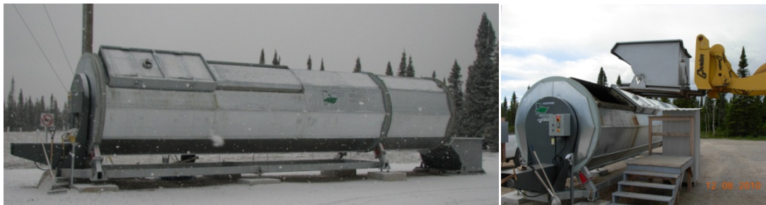
Figure 136: (a) Composteur modulaire de 32 pieds utilisé au camp La Romaine d'Hydro-Québec et (b) chargement du composteur à l'aide d'une benne versante (photos Paul Larouche).
