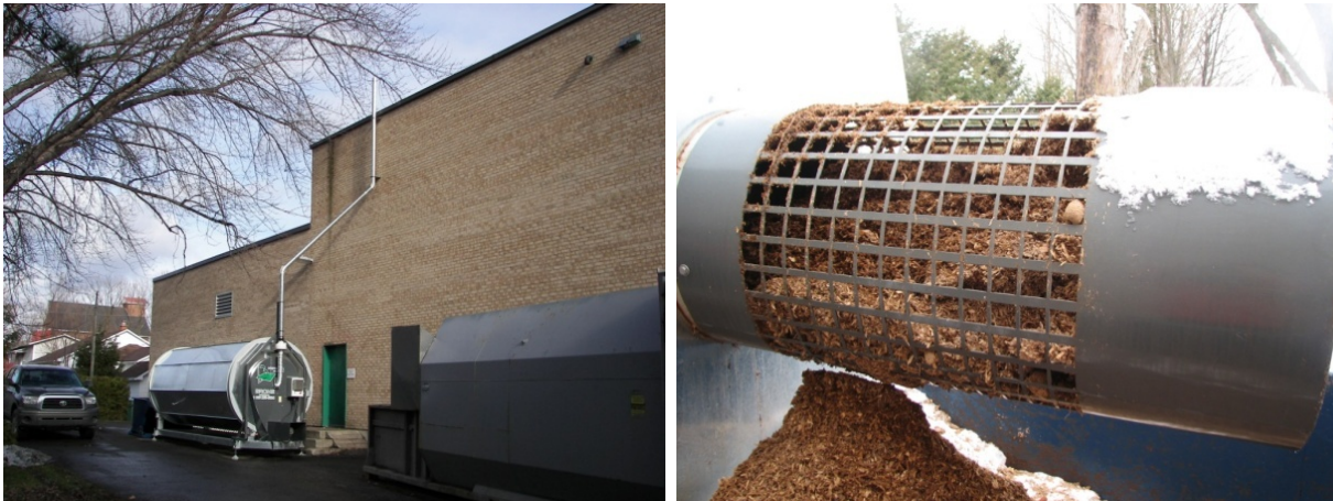
Figure 131: Équipements complémentaires ajoutés au bioréacteur (a) une cheminée qui permet de diffuser l'air sortant du composteur et (b) tamis permettant de séparer le compost des débris récalcitrants ayant un trop gros diamètre (photos Paul Larouche).
