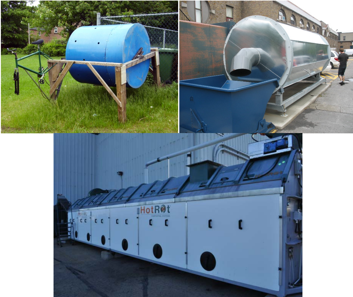
Figure 22: Cylindres rotatifs ou bio-réacteurs (a) de type artisanal et (b) de type industriel. (c) Dans ce système cylindrique, ce n'est pas le cylindre lui-même qui tourne mais bien un mécanisme à l'intérieur de la machine qui fait avancer le compost depuis l'entrée vers la sortie du composteur. (Photos Louise Hénault-Ethier)
