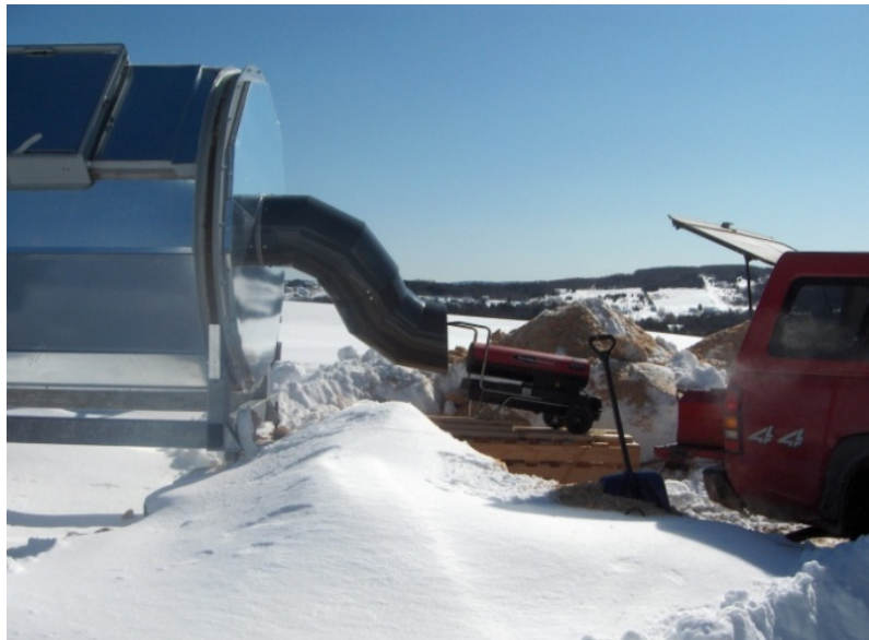
Figure 62: Démarrage d'un bio-réacteur en hiver à l'aide de brûleurs pour aider l'initiation du compostage et l'élévation initiale de température. Ensuite, le composteur n'aura plus besoin d'apport calorique supplémentaire (photo Paul Larouche).
