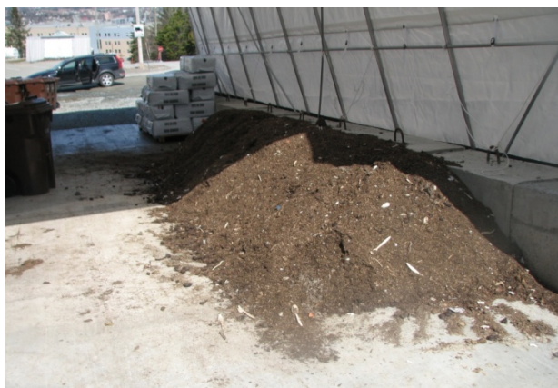
Figure 102: Pile de maturation du compost sous abri et sur une dalle de béton (photo: Paul Larouche).
