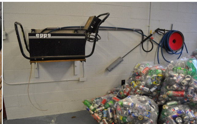
Figure 39: Nettoyeur à pression pour laver les bacs (photo Alexis Fortin).
