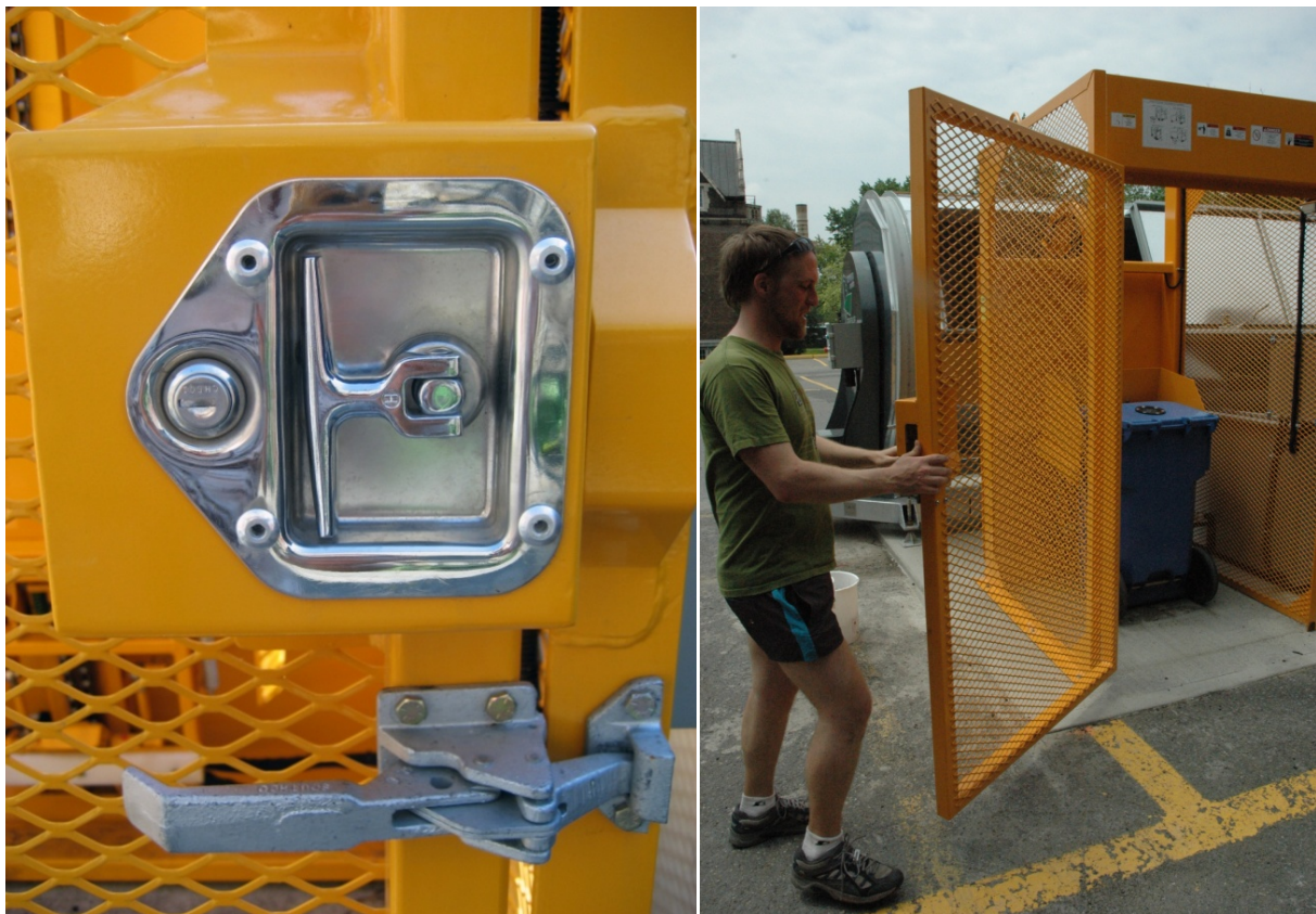
Figure 57: (a) Porte de sécurité sur une levée mécanique. (b) La levée mécanique ne peut être opérée si la porte n'est pas fermée (photos Alexis Fortin).
