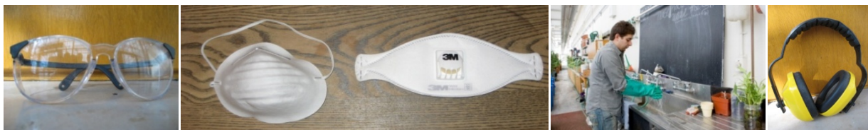
Figure 52: Équipements de protection personnelle recommandés pour certaines opérations de compostage : (a) lunettes de sécurité, (b) masque à poussière et masque à particules fines (N95), (c) gants et (d) casque de protection auditive (Photos Louise Hénault-Ethier).
