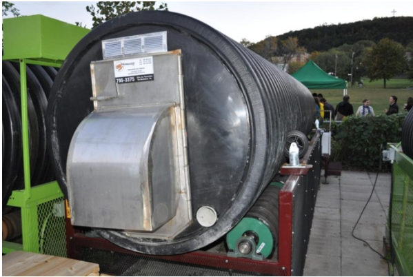
Figure 130: Nouveau réacteur de compostage amélioré installé à l'automne 2009 au site Le Tournesol (photos Alexis Fortin).
