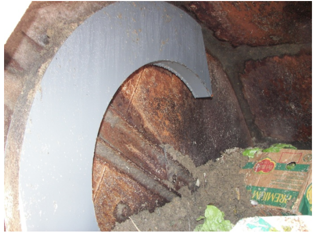
Figure 75: Une expérience concluante dans une épicerie démontre que les boîtes de carton ondulé et de carton ciré peuvent dans certaines conditions être compostées entières, sans être déchiquetées auparavant (photo Alexis Fortin).
